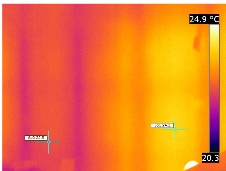
Figur 7. Termografering av väggs insida från fältundersökningen. Bilden visar yttemperaturer vid en varm solig sommardag efter flera timmars exponering. Bakom den vänstra halvan av väggen finns det gröna klimatskalet och bakom den högra referensväggen. De mörkare lodräta linjerna visar träreglarna.
